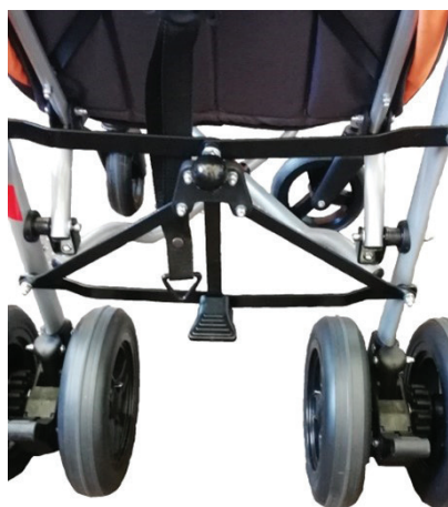
Ryc. 10. Tylna blokada wózka zwolniona
