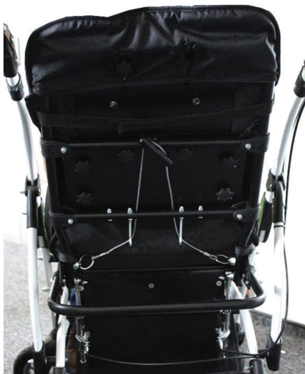
Ryc. 29B. Mechanizm regulacji kąta siedziska w wózku Junior Plus 3
